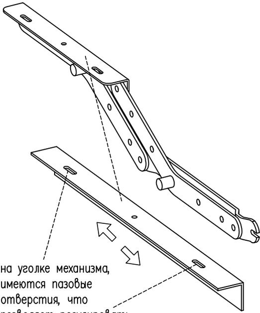
на уголке механизма, имеются пазовые отверстия, что позволяет регулировать сиденье по горизонтали.
